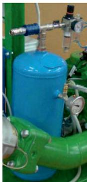
На единой раме установлен баллон со сжатым воздухом V= 15л., давление до 10 бар (145 PSI).
